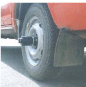
Рис. 6. Крепление одометра на колесе
